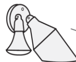
Shielded / Properly-aimed PAR Floodlights
